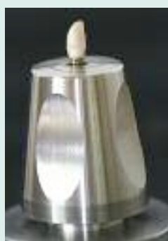
In den Frässockel eingespanntes Abutment
