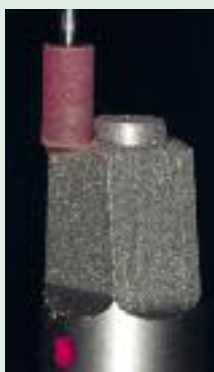
Der Radius für die Hohlkehle wird angelegt, der rote Glanzpolierer auf 2° abgerichtet und das Teleskop poliert
