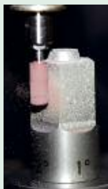
Der Radius für die Hohlkehle wird angelegt, der rote Glanzpolierer auf 2° abgerichtet und das Teleskop poliert
