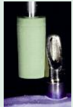
Ein Titanabutment wird mit dem braunen Polierer vorpoliert und mit dem grünen Polierer auf Hochglanz poliert
