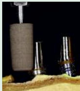
Ein Titanabutment wird mit dem braunen Polierer vorpoliert und mit dem grünen Polierer auf Hochglanz poliert
