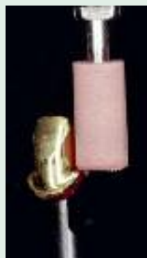
Der Radius für die Hohlkehle wird angelegt, der rote Glanzpolierer auf 2° abgerichtet und das Teleskop poliert
