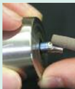
Fräsen mit einer 2-Grad-Metallfräse von Komet
