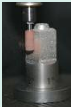
Abrichten des Gummipolierers mit Abrichtset 446 Komet
