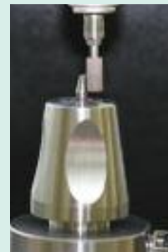
Glätten des Abutments mit Frästechnikpolierer 9440C/M/F123.060
